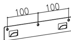
Привинтите и закрепите кронштейн на стене с помощью прилагаемых винтов и дюбелей.
